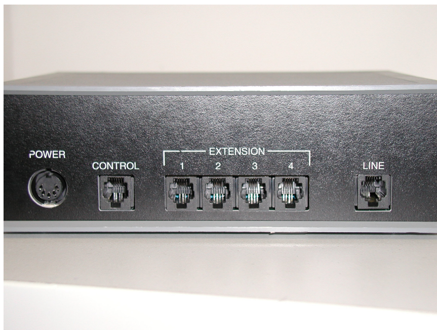
Bild 4: Rückansicht eines Modemsplitters mit vier Ausgängen der Firma dataprobe
