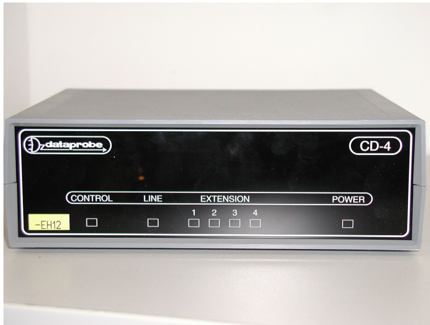
Bild 3: Frontansicht eines Modemsplitters mit vier Ausgängen der Firma dataprobe
